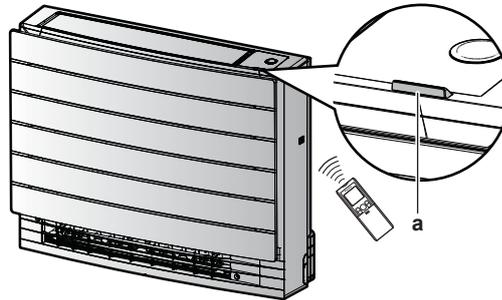
a Récepteur de signaux infrarouges
