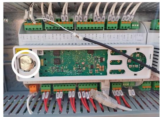
Veiller à ne pas endommager le couvercle. La nouvelle batterie peut être placée dans le support de batterie prévu à cet effet (surligné dans la photo ci-dessous) en respectant les polarités indiquées sur le support.
