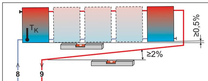
Fig. 4-1 Groupe de capteurs solaires raccordé en alternance (recommandé)
