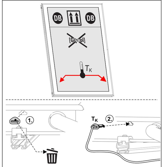
Sonde de température de capteur  $T_K$ Solar
