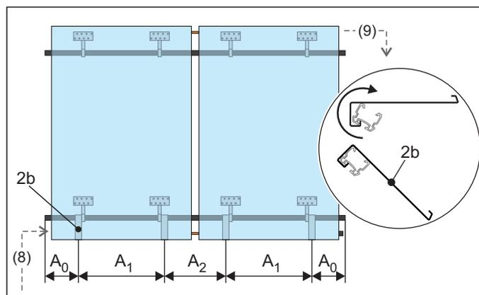
Fig. 4-8 Étape 1 : alignement des crochets de sécurité (Légende, voir tab. 4-1, dimensions, voir tab. 4-3)
