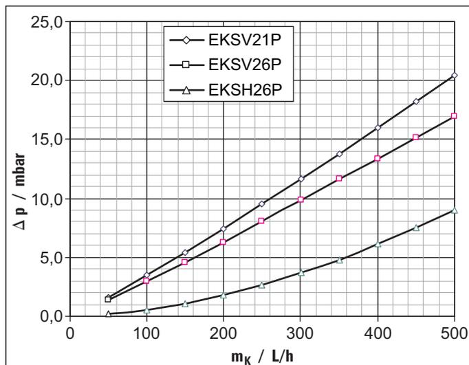
Fig. 6-1 Résistance hydraulique capteurs solaires plats
