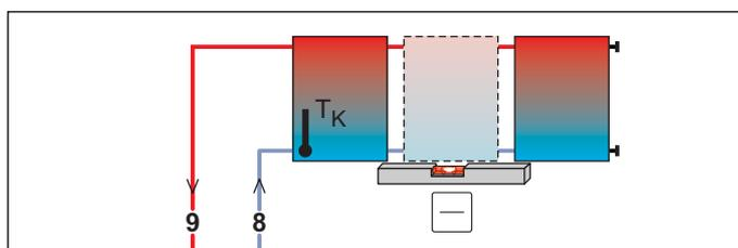
Fig. 4-2 Groupe de capteurs solaires raccordé équitalement (3 capteurs solaires max.)
