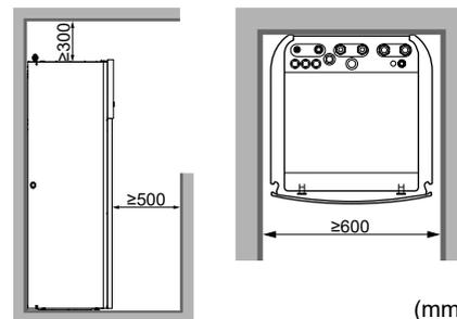
Outre les consignes d'espacement: étant donné que la charge de réfrigérant totale dans le système est  $\geq 1,84$  kg, la pièce où vous installez l'unité intérieure doit également être conforme aux exigences énoncées dans la section "4.1.3 Configurations d'installation" [p 7].
