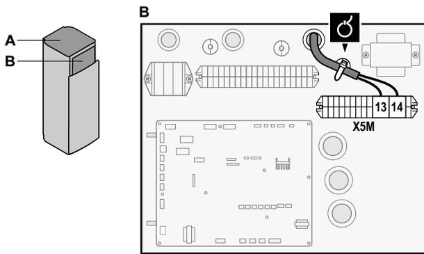
3 Fixez le câble avec les attache-câbles sur les supports d'attaches.
