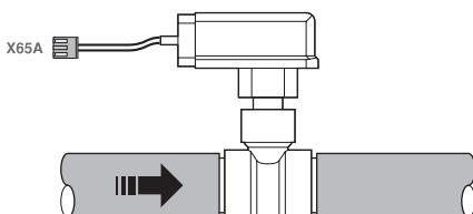
Na caixa de distribuição existe um terminal (X65A) para fazer a ligação eléctrica do fluxostato (S10L).
