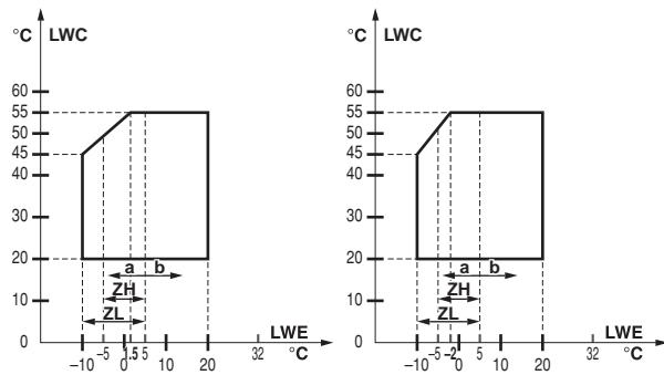
LWC Температура воды на выходе из конденсатора
