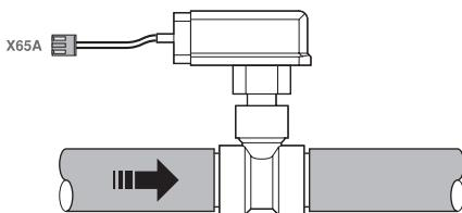
In de schakelkast steekt een klem (X65A) voor de elektrische aansluiting van de debietschakelaar (S10L).
