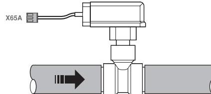
Nella morsettiera sono previsti due morsetti (X65A) per il collegamento del flussostato (S10L).
