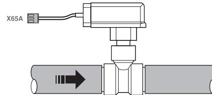
Для подключения реле протока (S10L) на электрическом щитке имеется соответствующая клемма (X65A).
