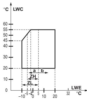
LWC Температура воды на выходе из конденсатора
