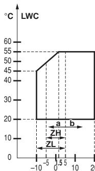
LWC Temperatura del agua de salida del condensador
