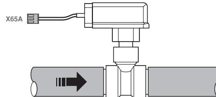
En la caja de conexiones se incluye un terminal (X65A) donde se conecta el interruptor de flujo (S10L).
