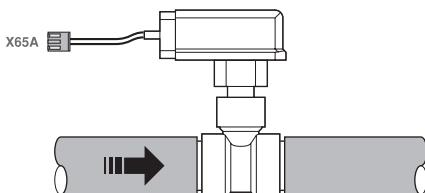
Zur Stromversorgung des Strömungsschalters (S10L) ist eine Klemme (X65A) im Schaltkasten vorhanden.
