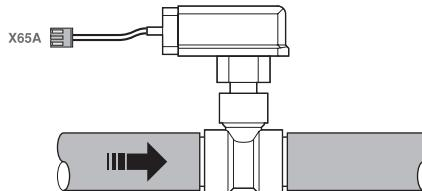
Une borne (X65A) est prévue dans le coffret électrique pour permettre le branchement électrique du contacteur de débit (S10L).
