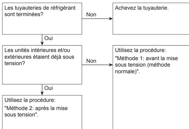
Il est très important que toute la tuyauterie de réfrigérant soit réalisée avant que les unités (extérieure ou intérieure) soient mises en service.
