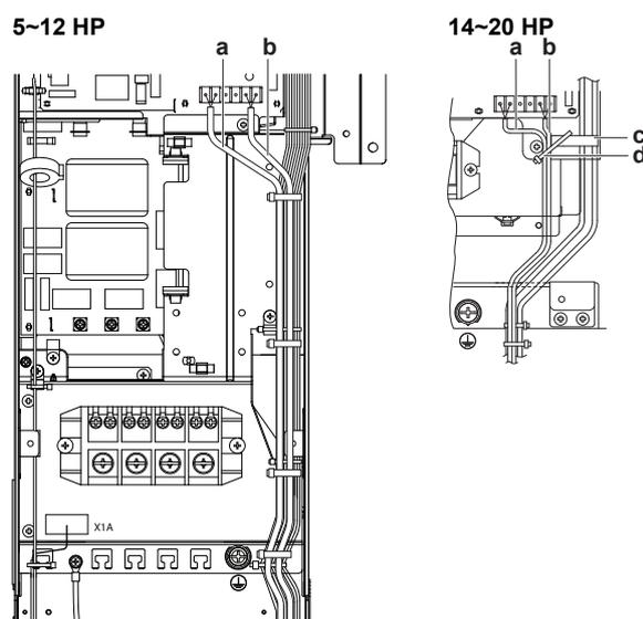
A fixer aux supports en plastique indiqués à l'aide de matériaux de fixation à fournir.
